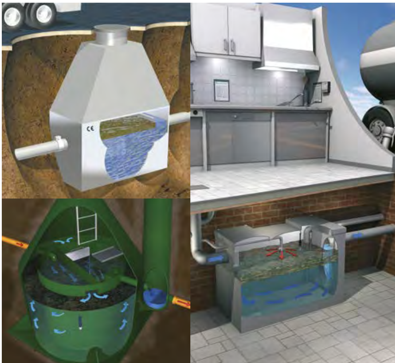
Eksempel på udskilleranlæg inde og ude og med ekstern tøm og spul.
